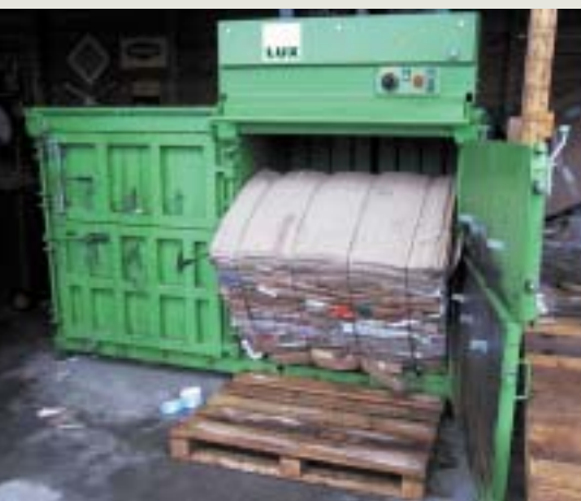
Dvoukomorový lis L30-2 - ukázka vyklápní balíku na paletu - kartonáž, 390kg
