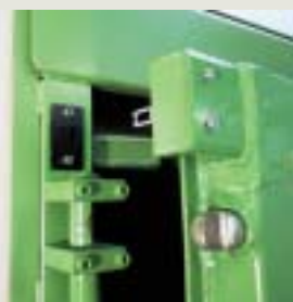
Kódovaný bezpečnostní spínač dle EN 60-947-5-1
