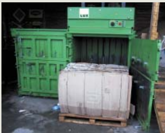
Dvoukomorový lis L30-2 - ukázka vyklápní balíku na paletu - kartonáž, 390kg
