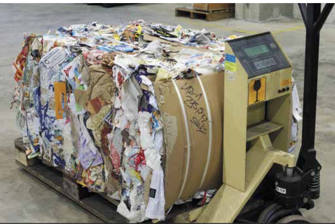
Hmotnost slisovaného balíku běžného smíšeného papíru je až 290 kg
