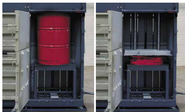
Úprava lisovací komory na lisování sudů, barelů a plechovek. Možnost dodání záchytné vany pro sběr zbytkových tekutin z lisovaného materiálu.
