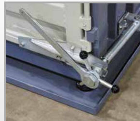
Bezpečnostní zajištění dveří při lisování expanzivních materiálů
