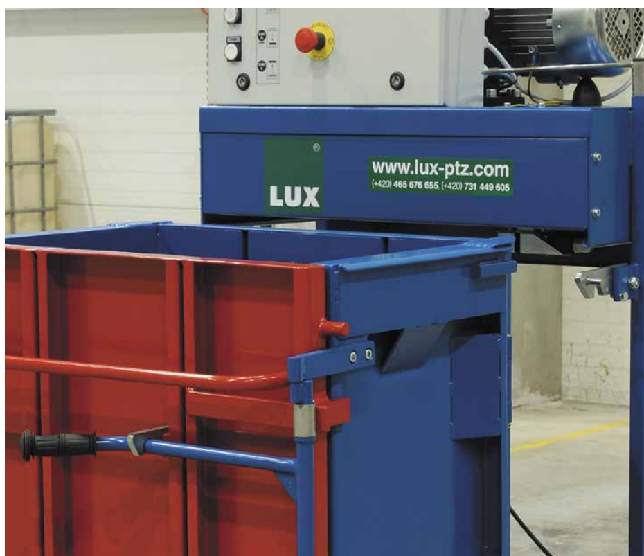
Nejmenší možné technologické mezery zamezují riziku zranění
