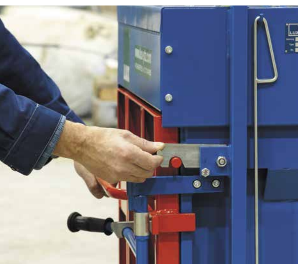
Bezpečnostní pojistka zajišťuje správnou polohu lisovací komory v lisu
