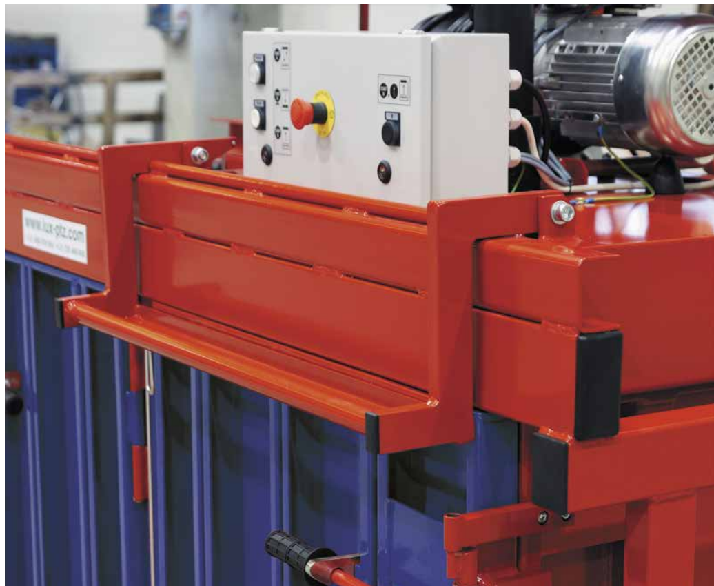
Lisy jsou lakovány práškovou barvou (komaxitem), která se vyznačuje dlouhodobou barevnou stálostí a leskem
