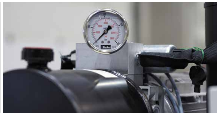
Pro bezpečnost obsluhy všech našich lisů umožňujeme aktuální vizuální kontrolu tlaku v hydraulickém systému
