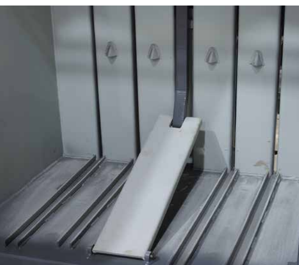
Těžké slisované balíky jsou z lisu vyklopeny vyklápěcí klapkou
