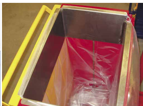
Forma pro uchycení igelitového pytle v lisovací komoře lisu L3-VK
