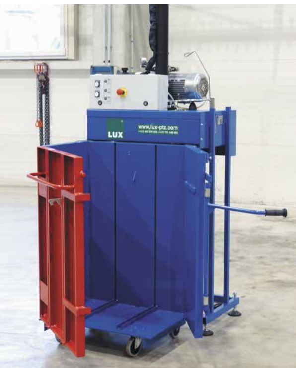
Pohyblivá boční stěna lisovací komory pro snadné vyjmutí slišaného balíku
